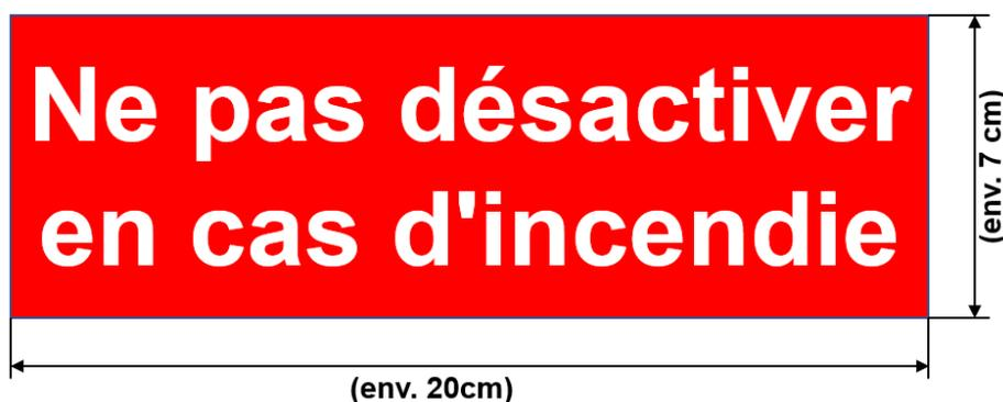
*Remarque : l'avertissement doit être placé sur la face avant de la porte de l'armoire.*
